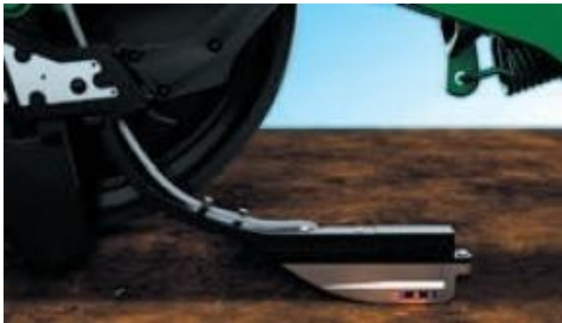
Рис. 5.- Датчик Smart Firmer система SmartDepth фірми Precision Planting
