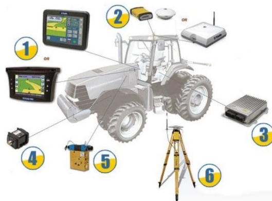
Рис. 2 - Схема складових системи автопілотування на прикладі Trimble AgGPS
