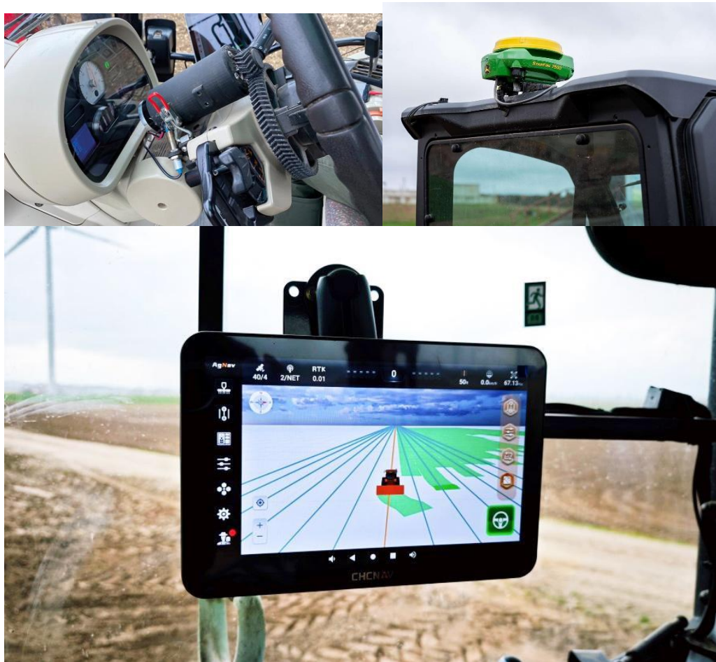
Рис. 2 - Монтаж системи автоматичного керування
