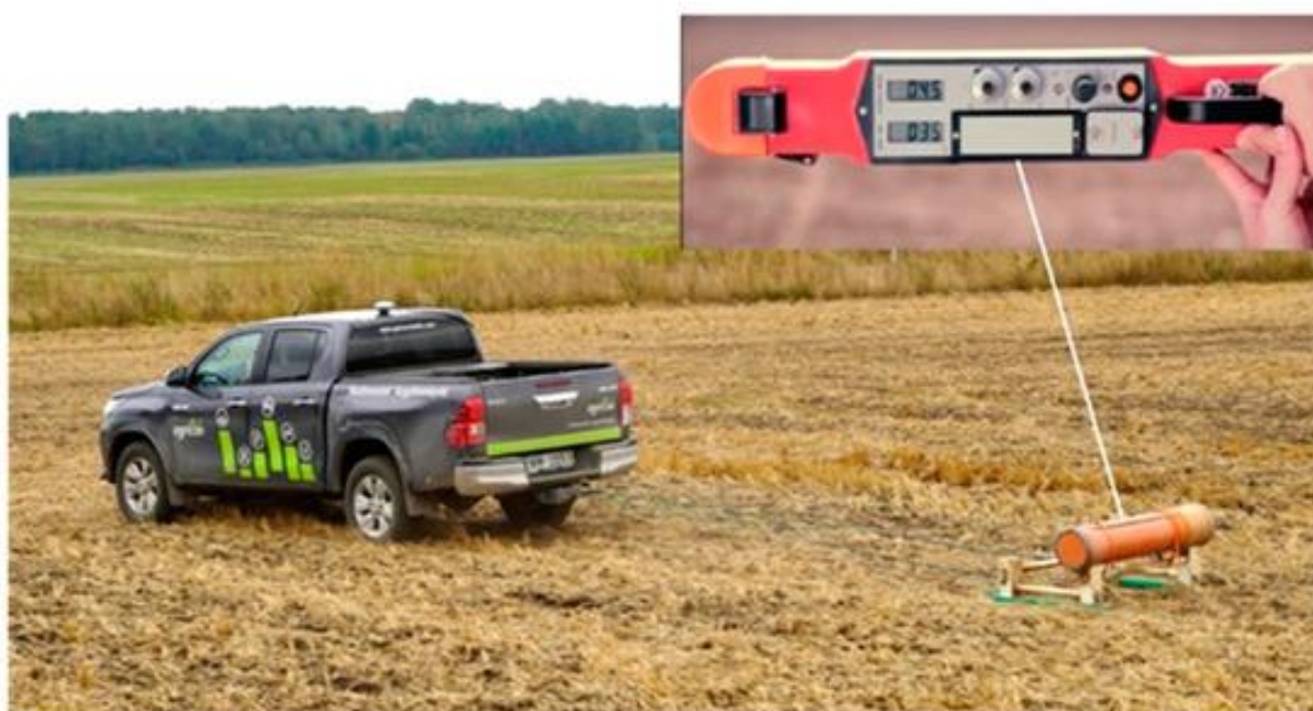
Рис. 1 - Пристрій дистанційного зондування EM38-MK2, побудований на пластикових санчатах
