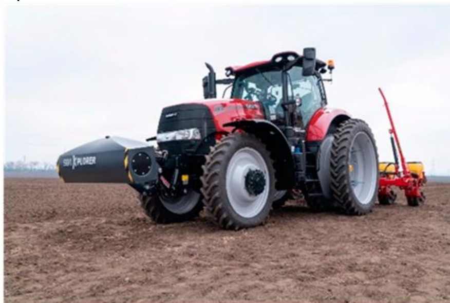
Рис. 4 - Пристрій SoilXplorer для вимірювання відмінностей у структурі ґрунту.
