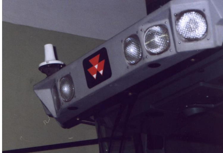
Рис. 3. - Установка приймальної антени ДГСП-сигналу на зернозбиральному комбайні MF-38
