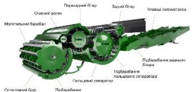
Рис.2.57 - Система обмолоту та сепарації комбайнів серії Т
