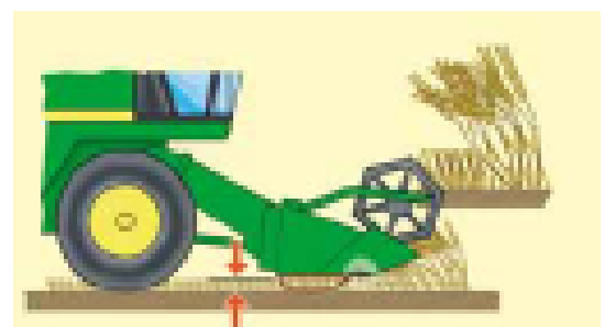
Рис.2.14 – Регулювання висоти зрізування
