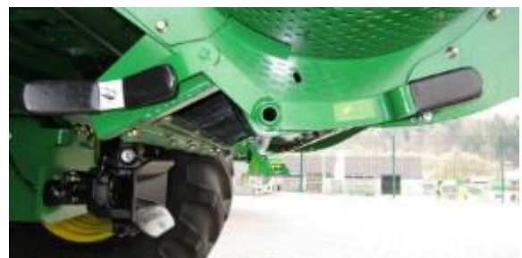
Рис.2.87 – Регулювання протиризальної пластини комбайнів серії S
