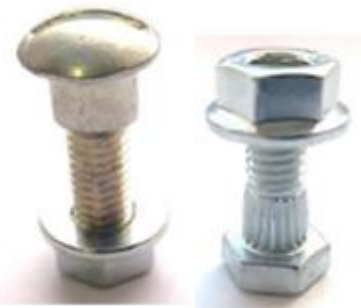
Рис.2.23 – Болтові з'єднання сегментів ножа
