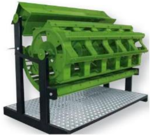
Рис.2.53 – Молотильний барабан комбайна серії 1470/1570
