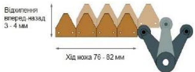
Рис.2.28 – Привід ножа – горизонтальний шатун
