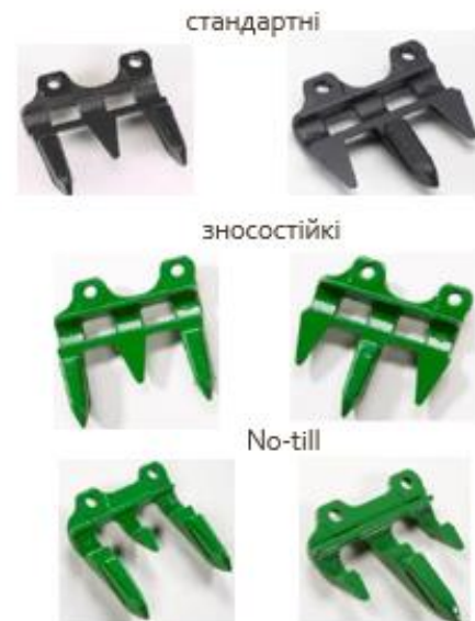
Рис.2.24 – Протирізальні пальці жатки 600 F
