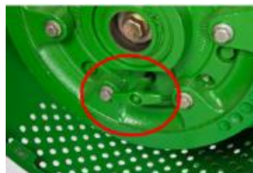
Рис.2.82 – Перемикання режиму видалення решток в комбайнах серії W
