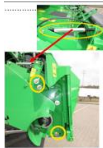
Рис.2.43 – Регулювання нахилу похилої камери
