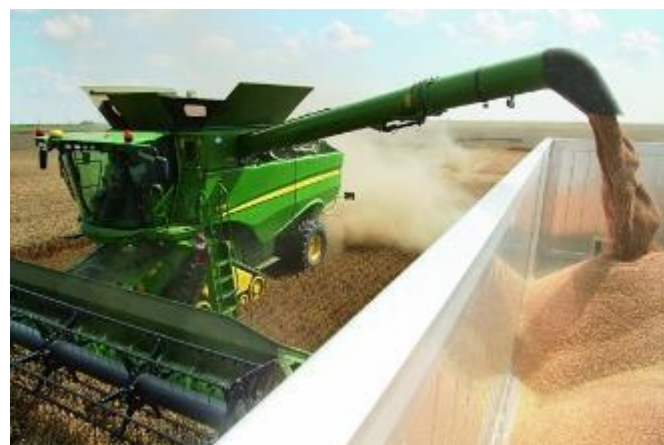
Рис.1.15 – Процес вивантаження зерна з бункеру комбайна
