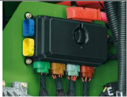
Рис.2.98 – Електросистема для діагностики CANBUS
