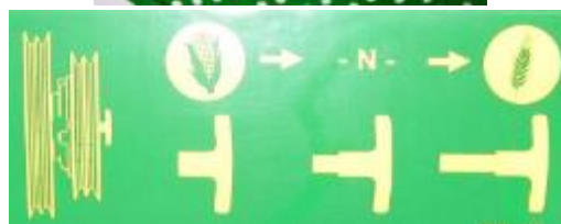
Рис.2.83 – Перемикання режиму видалення решток в комбайнах серії S
