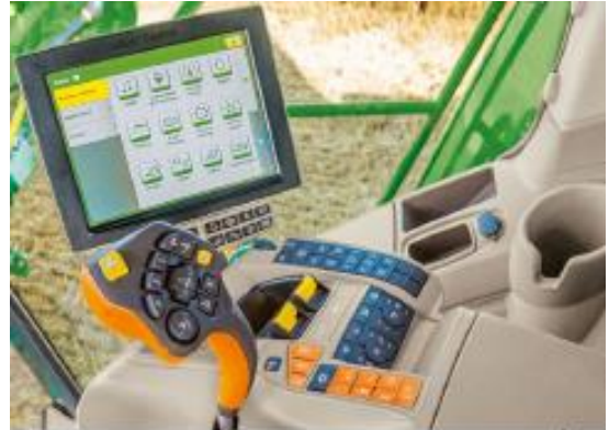
Рис.2.95 – Використання багатфункціонального джойстика для вибору режиму руху
