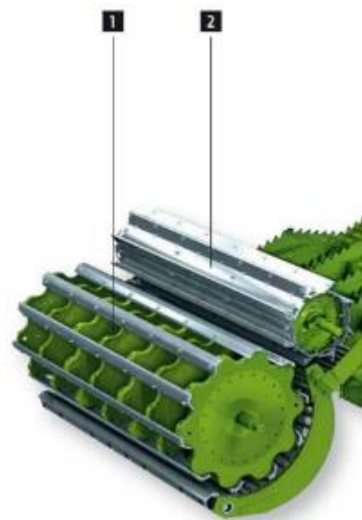
Рис.2.54 – Молотильно-сепарувальний пристрій зернозбирального комбайна серії W (1 – молотильний барабан; 2 – відбійний бітер)
