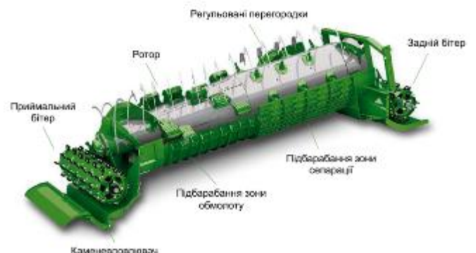
Рис.2.59 – Система обмолоту та сепарації комбайну серії S
