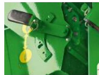
Рис.2.78 – Два положення підбарабання домолоту
