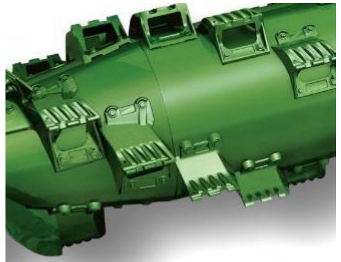
Рис.1.11 – Секція обмолоту комбайна Джон Дір S660
