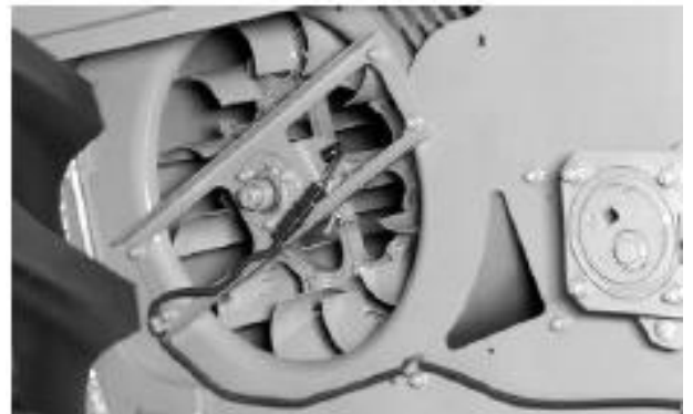
Рис.3.60 – Очищення зони навколо вентилятора: бічні щитки (А, В), стопор (С), щиток (D)
