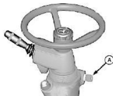
Рис.3.38 – Кнопки включення жатки (А) та сепаратора (В)
