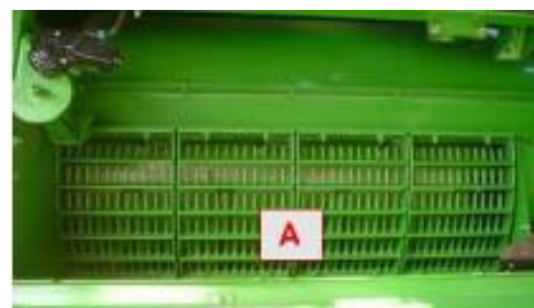
Рис.2.68 - Підбарабання зони сепарації
