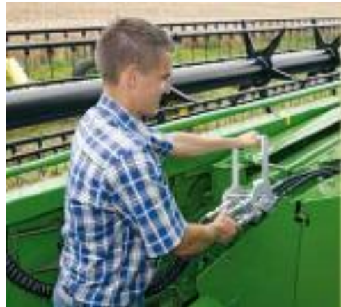
Рис.2.12 – Фіксація навіски жатки рукояттю
