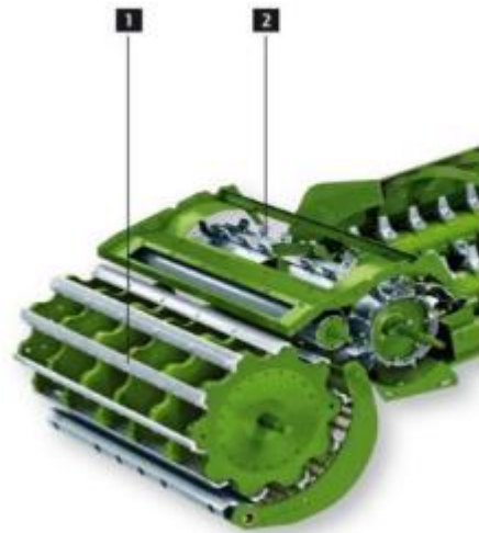
Рис.2.56 – Молотильно-сепаруючий пристрій зернозбирального комбайна серії С (1 – молотильний барабан; 2 – відбійний бітер)
