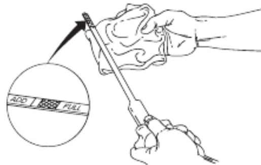
Рис.4.1 – Розташування щупу та позначки оптимального рівня
