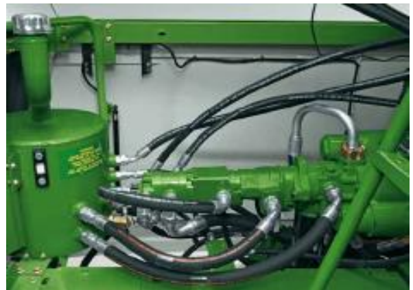
Рис.2.99 – Гідравлічна система з відкритим центром для швидкого реагування
