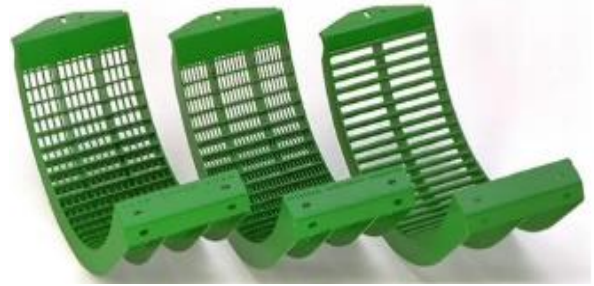
Рис.2.64 – Підбарабання в зоні обмолоту
