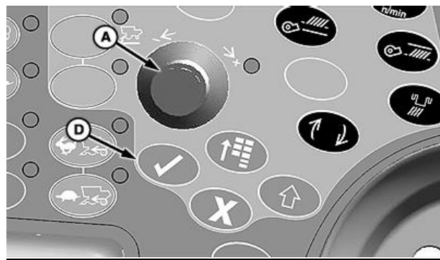
Рис.4.32 – Ручка вибору (А) та перемикач підтвердження (D)
