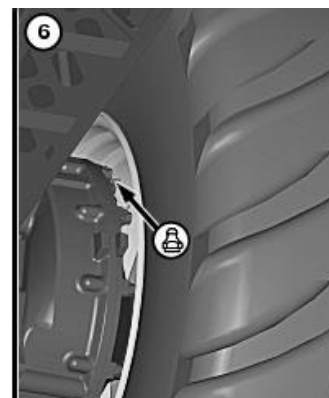
Рис.4.41 – Змащення зовнішніх підшипників кінцевої передачі
