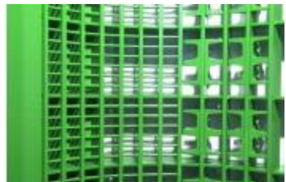
Рис.2.51 – Великокоміркове підбарабання з вкороченими прутками
