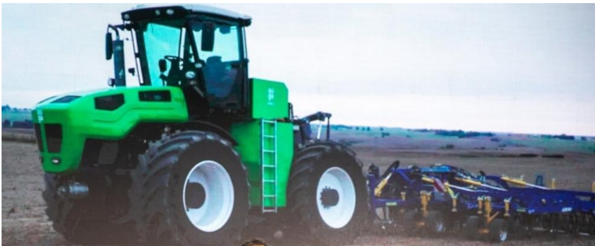
Рисунок 6.6 - Гібридний трактор з біометано-електричною паливною системою Auga Group AUGA M1
