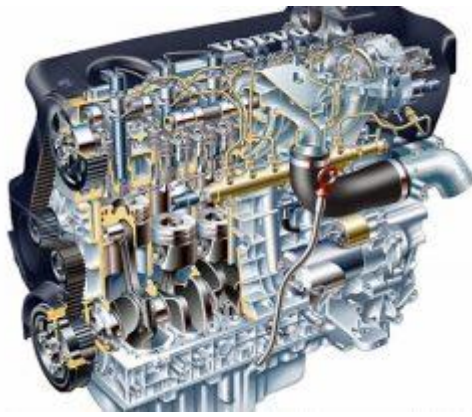
Рисунок 6.7 - Двигун з турбонаддувом і системою Common Rail
