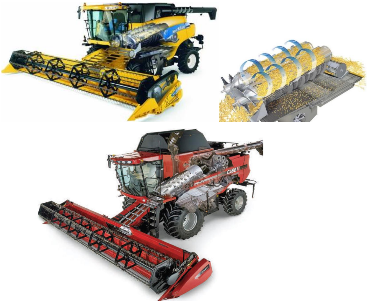
Рисунок 4.1 – Зернозбиральний комбайн із молотильно - сепарувальним пристроєм роторної схеми обмолоту
