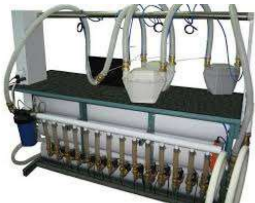
Рисунок 17.5. Установка для повірки побутових газових лічильників
