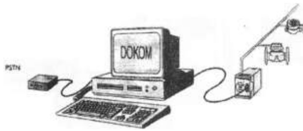
Рисунок 16.15 - Система автоматичного відліку показів вимірників тепла, води, електричної енергії, газу підключених on-line і off line, що функціонує з використанням програмного забезпечення Software DOKOM CS.
