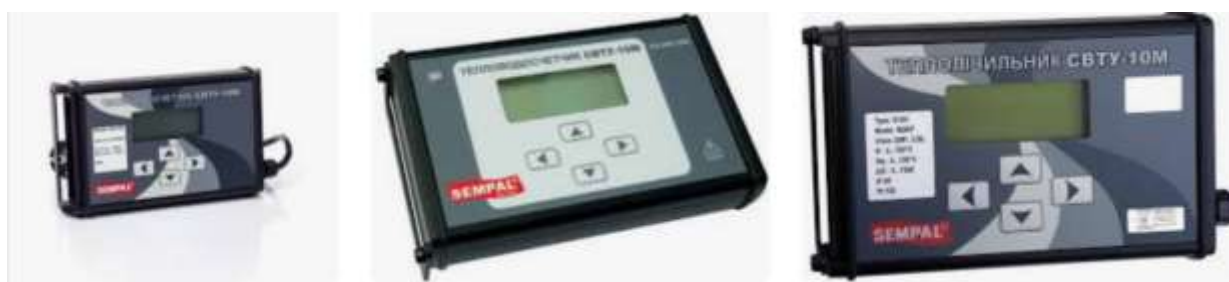
Рисунок 9.5. Приладовий комплекс обліку і регулювання витрат теплоносія на базі лічильника СВТУ-10М.
