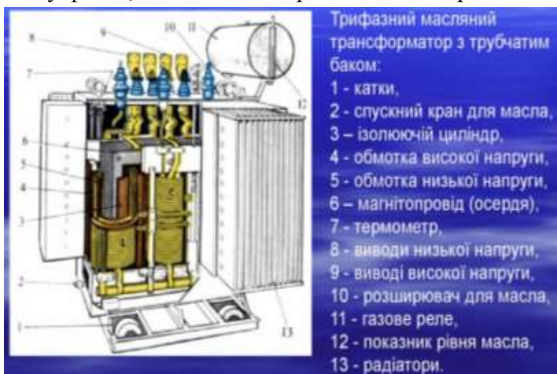
Будова трифазного трансформатора
