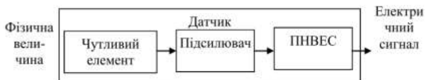
Рисунок 7.1 – Будова найпростішого датчика
