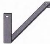
Рис. 1.109. Покрівельна консоль на дах, вкритий жерстю або руберойдом
