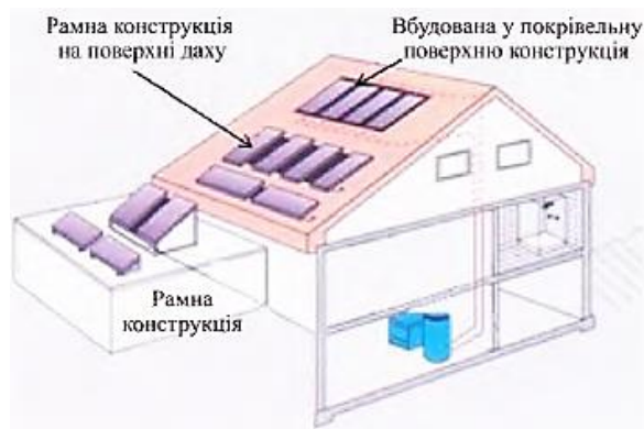
Рис. 1 - Способи монтажу сонячних колекторів
