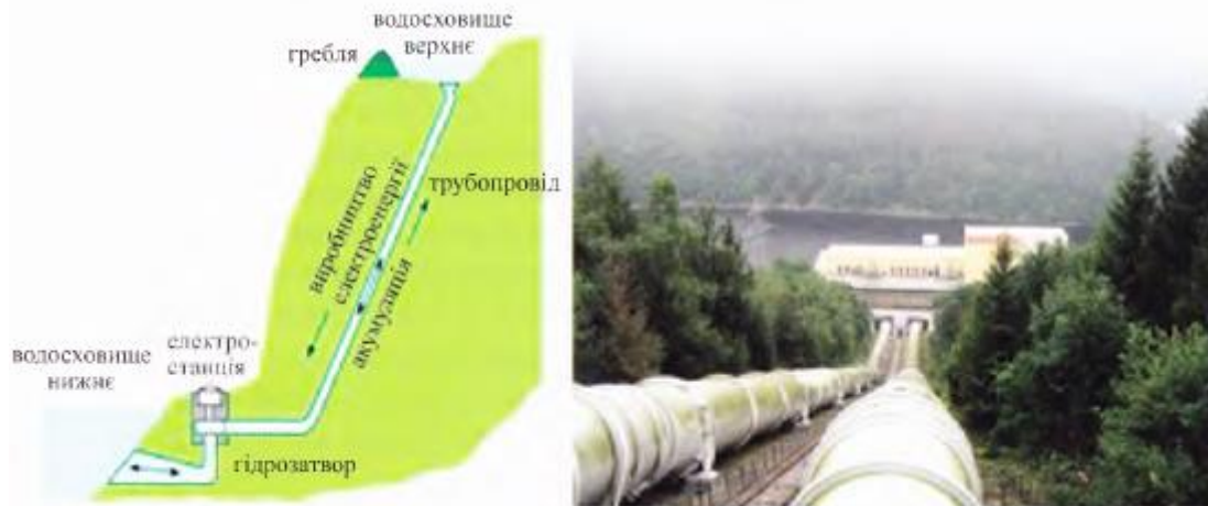
Рис. 4.10. Схематичне зображення та фото гідроакумулюючої електростанції
