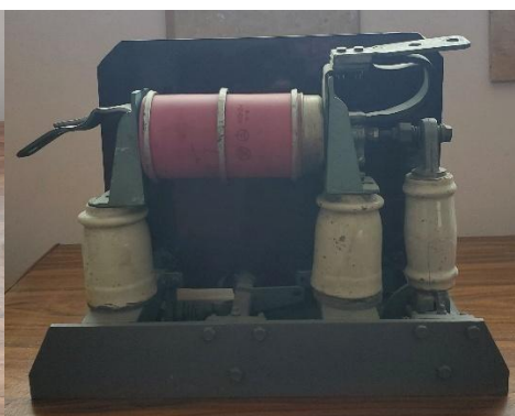
Рисунок 10.7 – Комутаційні пристрої, що використовуються для КСО-272, представлені у лабораторії кафедри енергетики та ЕТС СНАУ: а, б – камерний вакуумний вимикач навантаження виконання для КСО-272 з вакуумними дугогасильними камерами КДВ-21 (два види одного апарата); в – маломасляний силовий вимикач ВМГ-10
