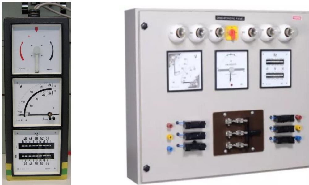
Рисунок 18.4 – Аналоговий набір для синхронізації електрогенератора
