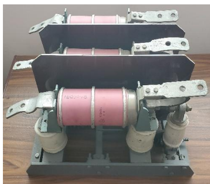
Рисунок 10.7 – Комутаційні пристрої, що використовуються для КСО-272, представлені у лабораторії кафедри енергетики та ЕТС СНАУ: а, б – камерний вакуумний вимикач навантаження виконання для КСО-272 з вакуумними дугогасильними камерами КДВ-21 (два види одного апарата); в – маломасляний силовий вимикач ВМГ-10
