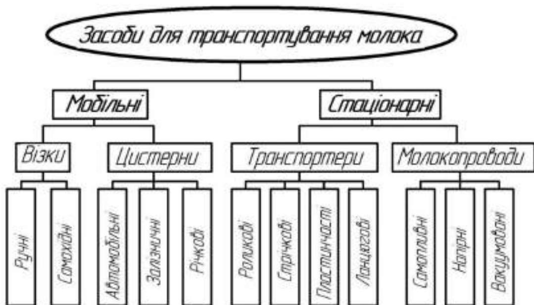
Рисунок 12.1. Класифікація засобів для транспортування молока
