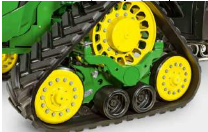
Гусенична каретка з підресорним центральним опорним роликом
