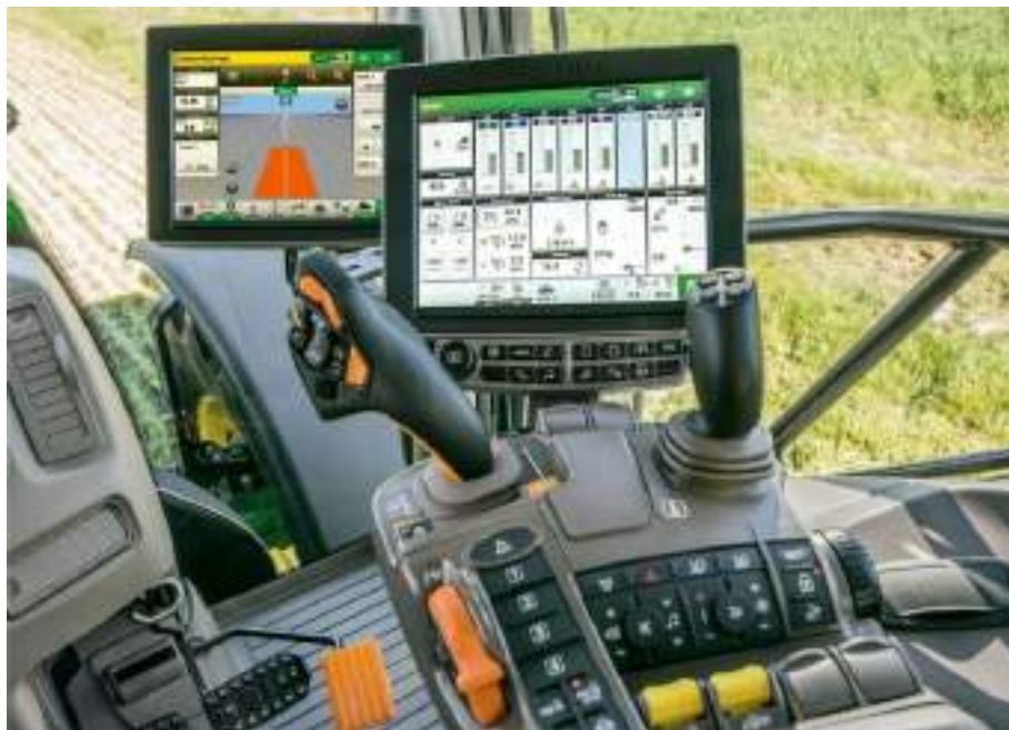
Дисплеї GreenStar в кабіні трактора John Deere моделі 8R
