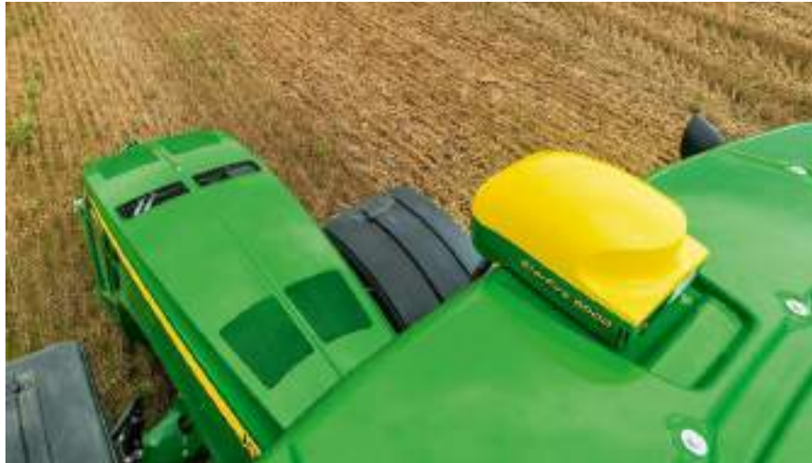
Установка приймача StarFire 6000 на тракторі John Deere
