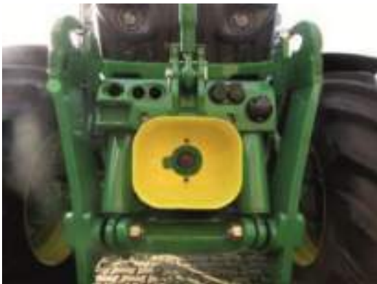
Передній вал відбору потужності (ВВП) зчіпки.
