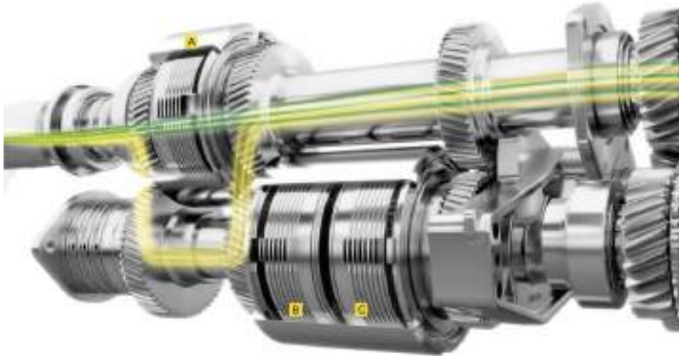
A – муфта вищої передачі; B – муфта нижчої передачі C – муфта PowrReverser
