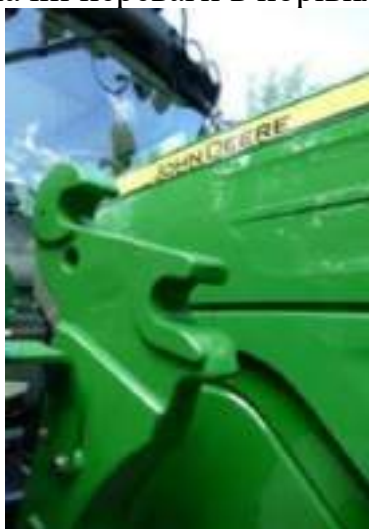
Кронштейн навантажувача, прикріплений до повнорамної конструкції
