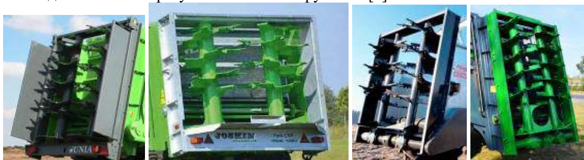
Рисунок 1. Вертикальні розкидальні робочі органи розкидачів добрив
