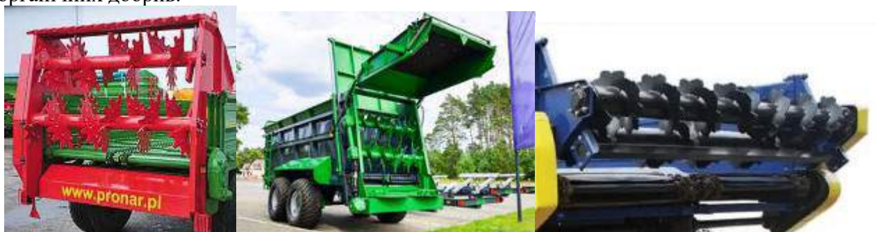
Рисунок 2. Горизонтальні робочі органи розкидачів добрив
