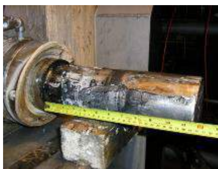
Рисунок 2 - Зношена підшипникова шийка валу
