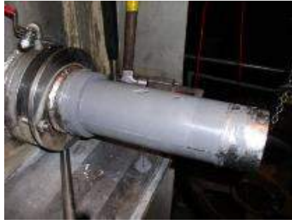
Рисунок 3 – Покриття, типу Belzona, нанесене на підшипникову шийку валу
