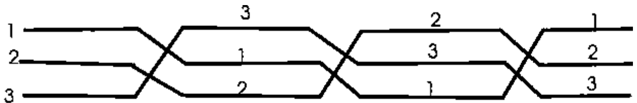
Рисунок 5.7 - Транспозиція проводів трифазної лінії
