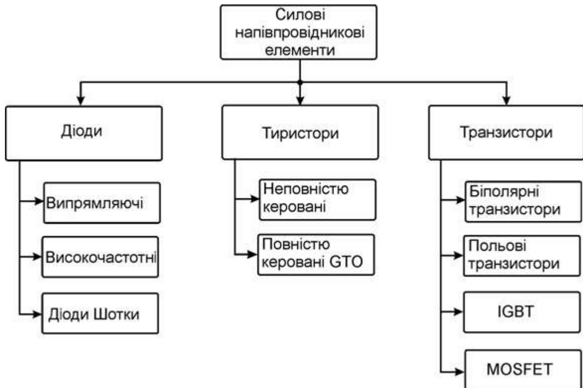
Рис. 1.1 Класифікація силових напівпровідникових приладів
