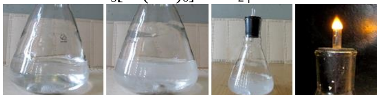
Рисунок 1.9 – Поетапний перебіг взаємодії алюмінію з лугом і згоряння водню, що виділився внаслідок реакції
