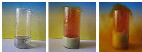
Рисунок 1.6 – Поетапна взаємодія олова Sn з концентрованою нітратною кислотою \text{HNO}_3 , внаслідок якої виділяється бурий газ \text{NO}_2
