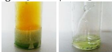
Рисунок 1.7 – Взаємодія ртуті: а) з концентрованою нітратною кислотою; б) з розведеною \text{HNO}_3
