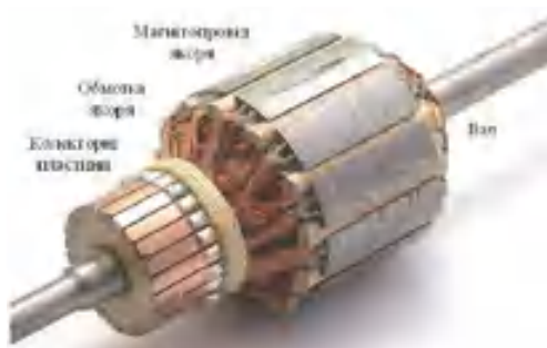
Рис. 16 Якір двигуна постійного струму
