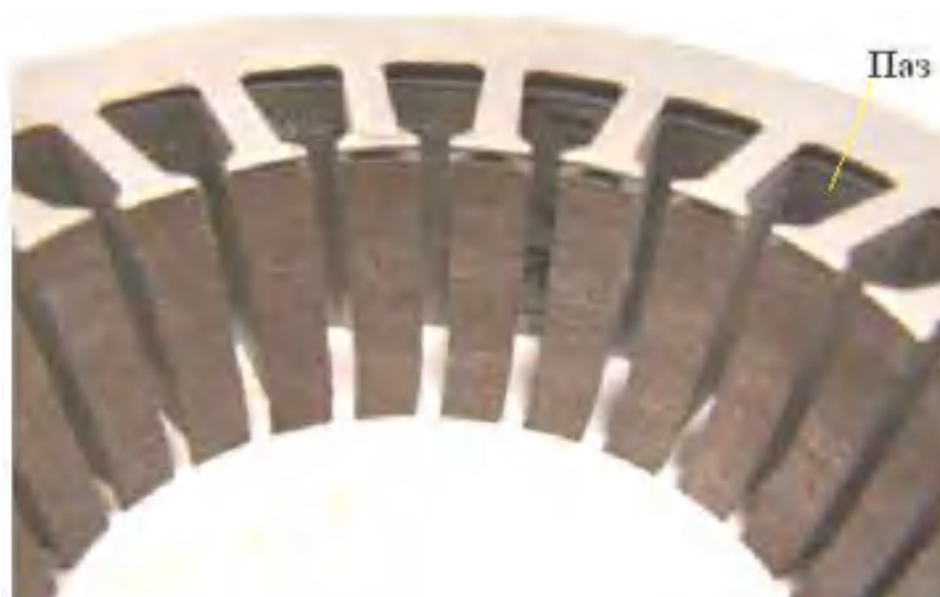
Рис. 9 Магнітопровід статора двигуна змінного струму
