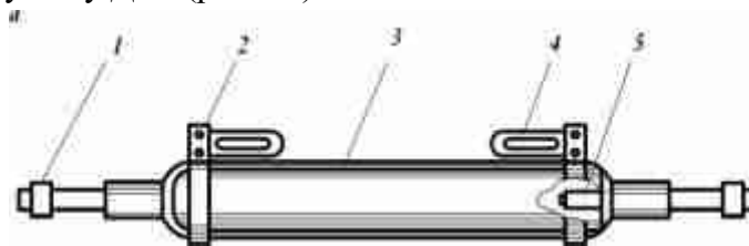
Рис. 10 – Конструкція лампи ДРТ: 1 – ввід; 2 – металеві хомутики; 3 – трубка із кварцового скла; 4 – тримачі; 5 – електроди;
