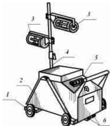
Рис. 7 – Установка для опромінення птиці УОК-1: 1 – самохідне шасі; 2 – привод від електродвигуна до ведучих коліс і пристрою укладки кабелю; 3 – опромінювачі з лампами ДРТ400; 4 – штанга; 5 – панель управління; 6 – кінцеві вимикачі
