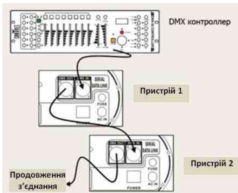
Рис. 3 – Спосіб і порядок підключення декількох світильників до одного контролера
