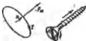
Рис. 7.1. Обертання головки гвинта в напрямку струму I зумовлює переміщення гвинта в напрямку вектора p
