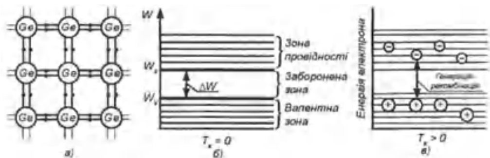
Рис. 5.1. Кристалічні ґратки чистого германію (а), енергетична діаграма напівпровідника при T_k = 0 і відсутність вільних зарядів (б), поява носіїв вільних зарядів (електронів і дірок) при T_k > 0 (в).
