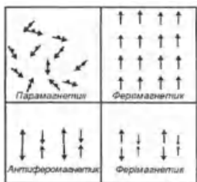
Рис. 7.6. Схема орієнтації магнітних моментів атомів різних матеріалів
