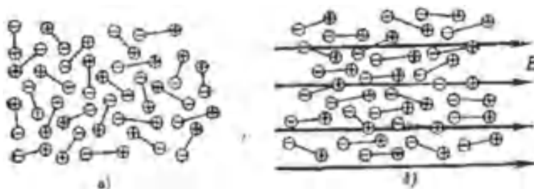
Рис. 6.6. Розміщення дипольних молекул а) до поляризації; б) після поляризації
