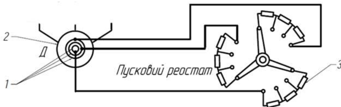
Рис. 9.1. Пуск асинхронного двигуна з фазним ротором за допомогою пускового реостата: 1 – контактні кільця фазного ротора; 2 – обмотка статора; 3 –
