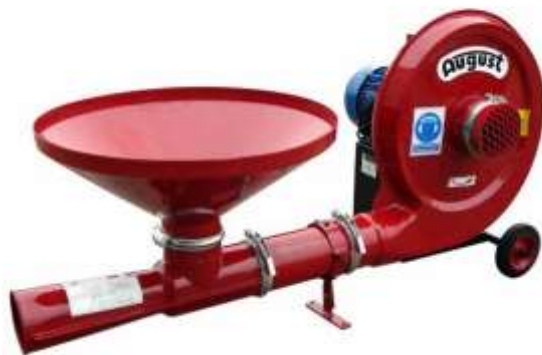
Рисунок 4.4.3 – Пневмотранспортер для зерна Т-378/2 (потужність двигуна 7,5 кВт, продуктивність 7,5 т/год, довжина транспортування 30 м, висота транспортування 12 м)
