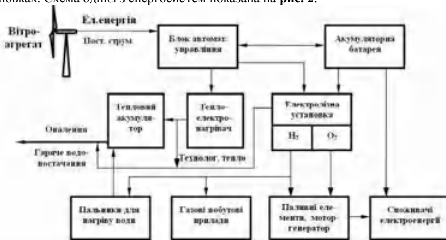
Рис. 2. Схема вітроводневої станції
