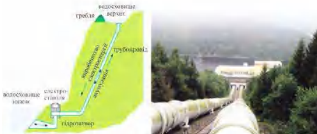
Рис. 4.10. Схематичне зображення та фото гідроакumuлюючої електростанції
