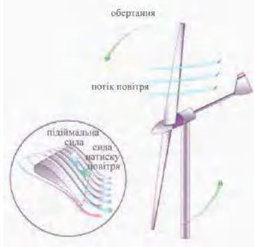
Рис. 5. Принцип роботи вітрової турбіни
