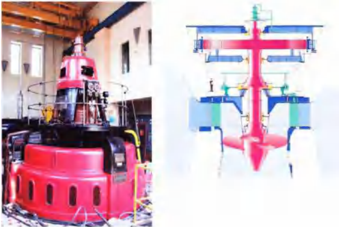
Рис. 12. Вигляд і розріз турбіни Каплана з синхронним електрогенератором
