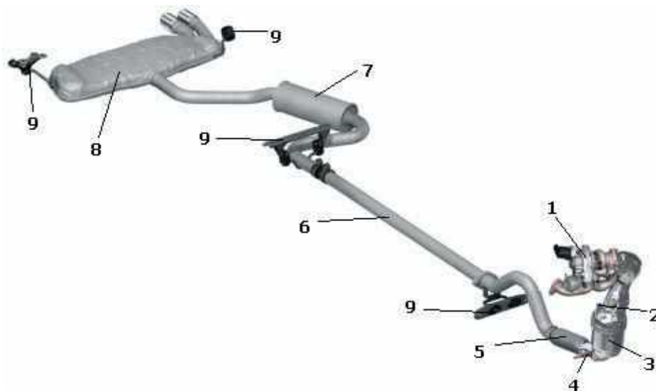
Рис. 10.Схема випускної системи.
