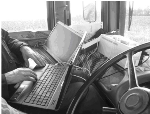
Рис. 4.3 - Розміщення вимірювально-реєстраційного комплексу в кабіні трактора ХТЗ-17221
