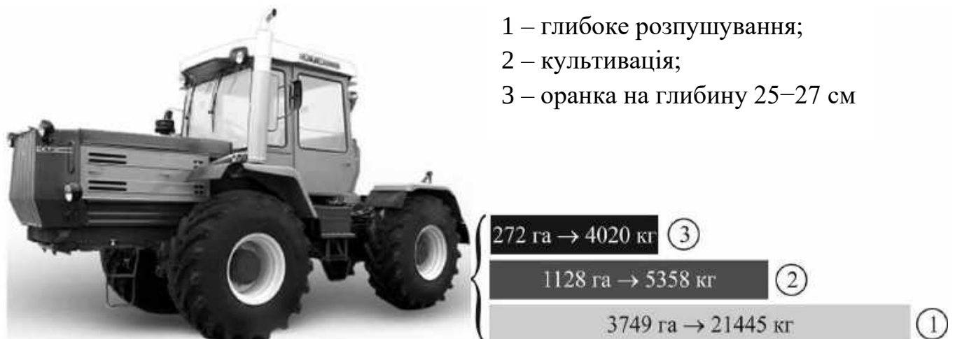
Рис. 1.2 - Обсяг (га) виконаних робіт і витраченого (кг) палива трактором ХТЗ-17224 за напрацювання 1395 мотогодин
