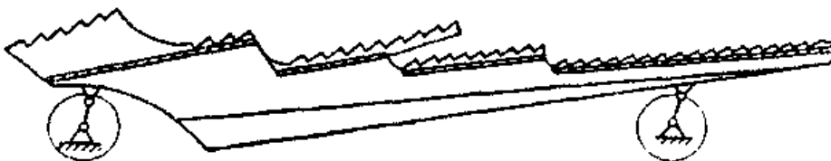
Рис. 6.14. Схема клавішного соломотряса:
