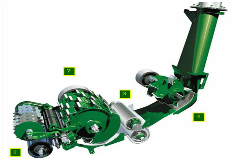
Рис.5.11. Технологічний процес роботи силосозбирального комбайну. 1- блок живильних вальців, 2- подрібнюючий барабан, 3 - подрібнювач кукурудзяних початків, 4 - прискорювач потоку маси.
