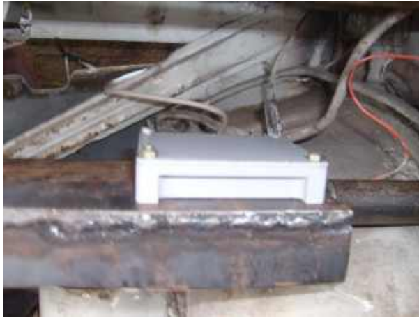
Рисунок 4.3 – Установка датчиків прискорень у багажнику випробовуваного автомобіля
