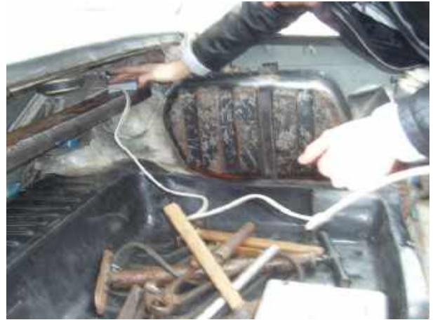
Рисунок 4.3 – Установка датчиків прискорень у багажнику випробовуваного автомобіля
