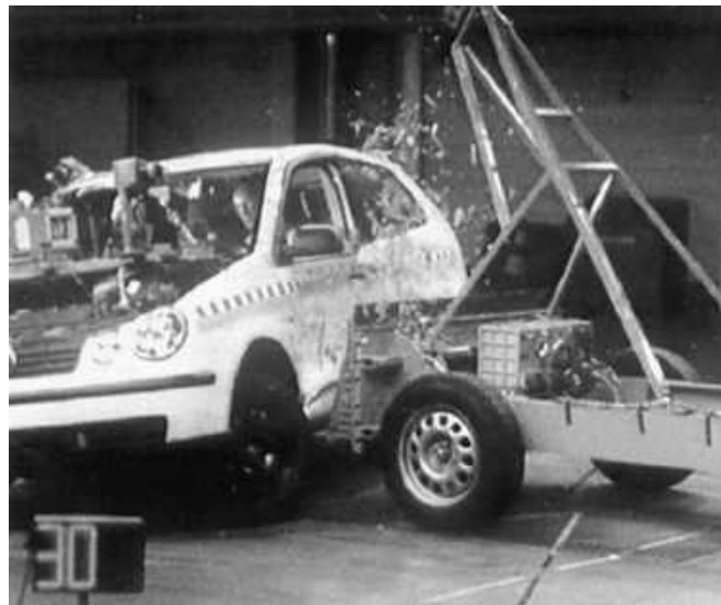
Рис. 8.3 Випробування автомобіля методом бічного удару
