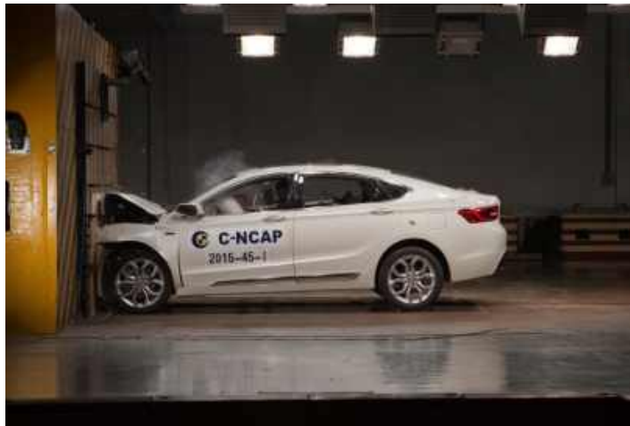
Рис. 8.1 Випробування автомобіля методом фронтального зіткнення з нерухомою перешкодою
