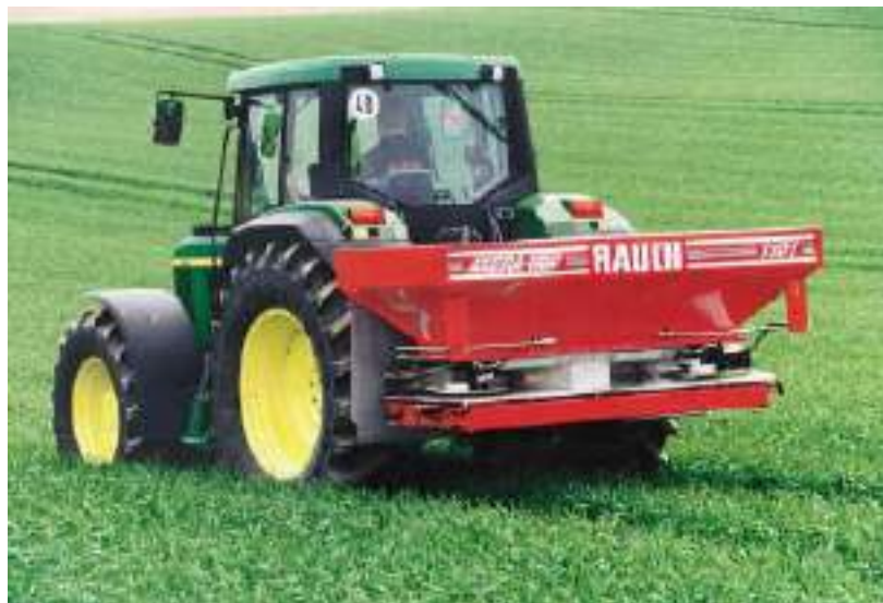
Рис. 5.2. Машинний агрегат з навісною агромашиною для внесення гранульованих мінеральних добрив.
