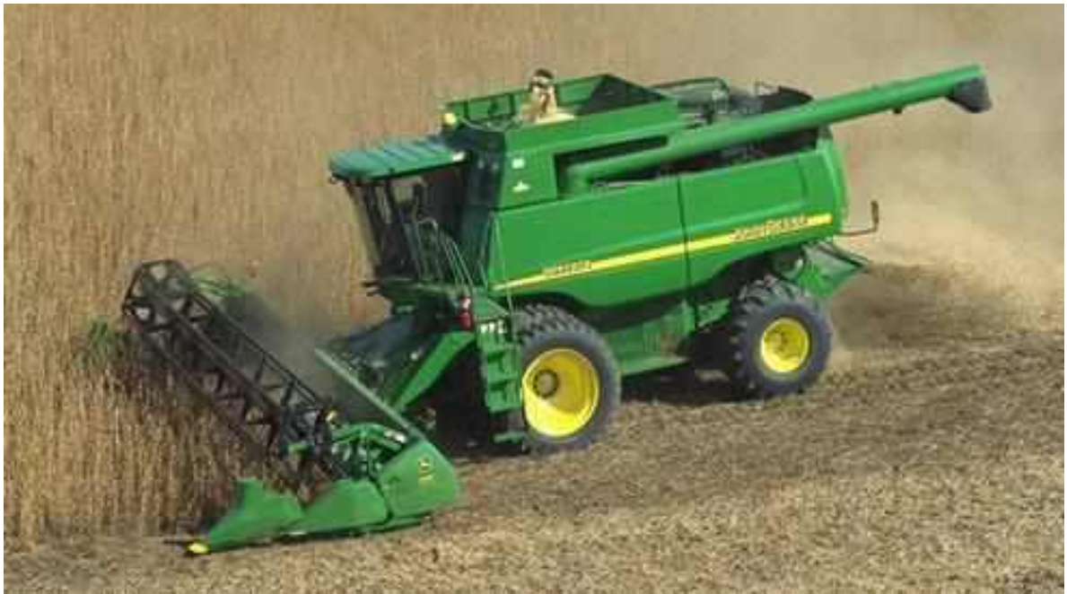
Рис. 5.4. комбайн, який проводить зрізання маси, обмолот, первинну очистку та будує карту врожайності поля.
