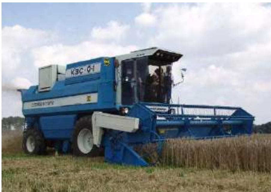
Рис. 2.28. Комбайн “Славутич” із пропускною здатністю 9-11 кг/с.
