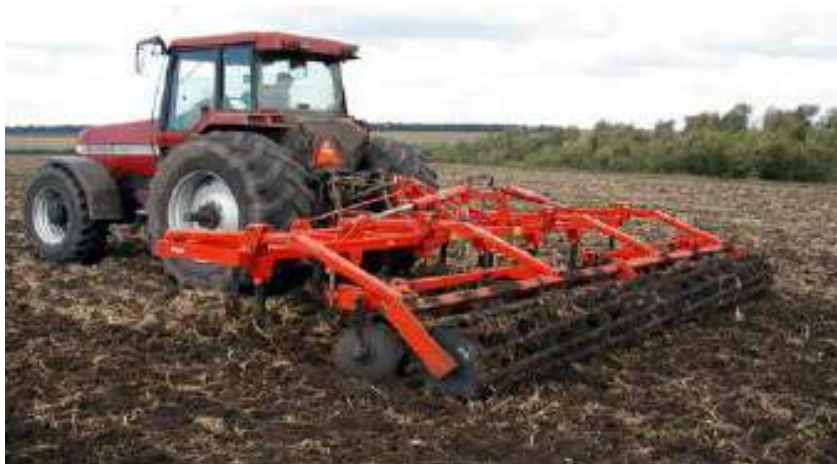
Рис. 5.1. Машинний агрегат до складу якого входить енергетичний засіб та агромашина з дисковими робочими органами.
