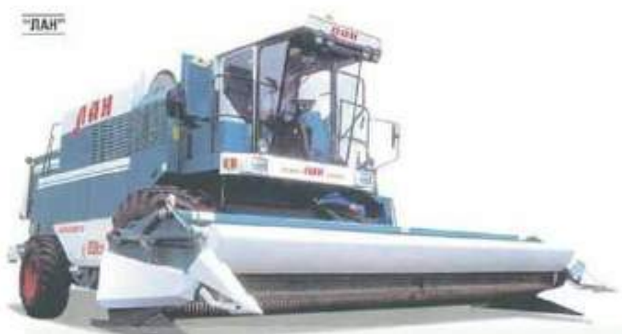
Рис. 2.27. Комбайн “Лан” із пропускною здатністю 7-9 кг/с.
