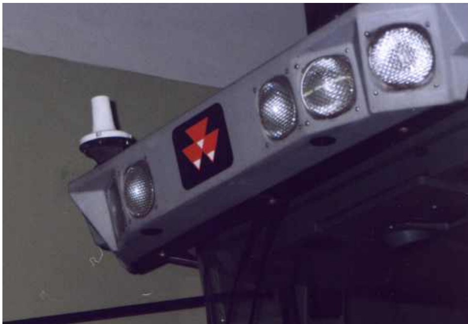
Рис. 2. - Установка приймальної антени ДГСП-сигналу на зернозбиральному комбайні MF-38
