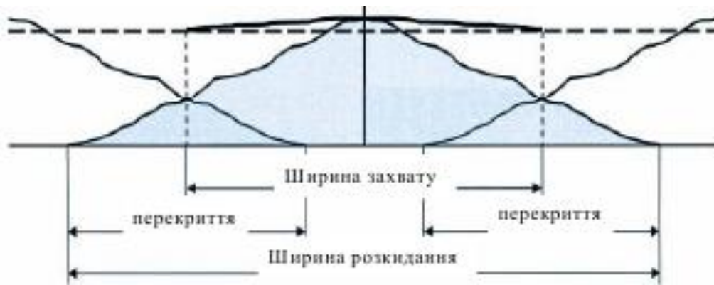
Рисунок 2 – Співвідношення між шириною захвату розкидача та шириною розкидання добрив
