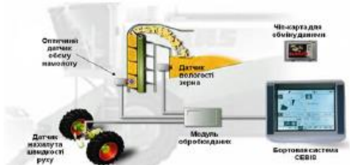
Рисунок 1 – Схема розміщення датчиків системи картографування врожайності на комбайні CLAAS
