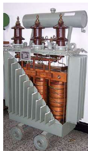
Трифазний силовий масляний трансформатор з вирізом у баку для демонстрації конструкції
