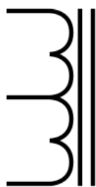
Умовне графічне позначення автотрансформатора
