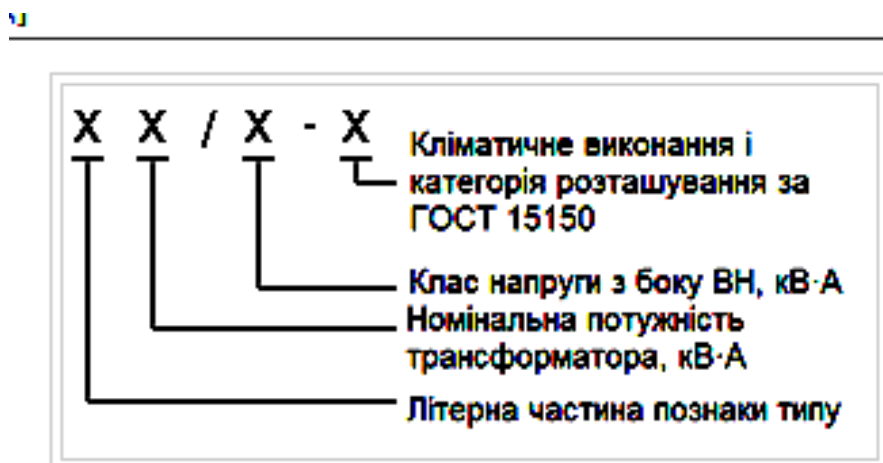
Структурна схема умовного позначення силового трансформатора за ГОСТ 11677-85
