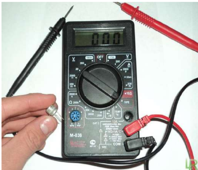
Рисунок 8.10 – Приклад перевірки транзисторів
