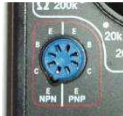
Рисунок 8.9 – Панель перевірки транзисторів
