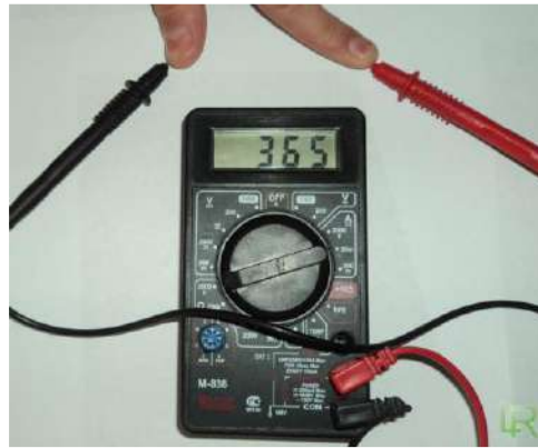
Рисунок 8.5 – Приклад заміру опору нашого тіла
