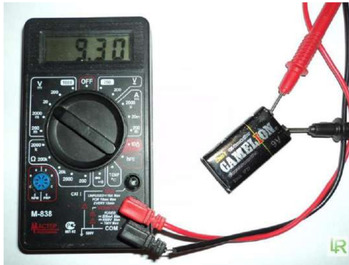
Рисунок 8.3 – Приклад вимірювання напруги
