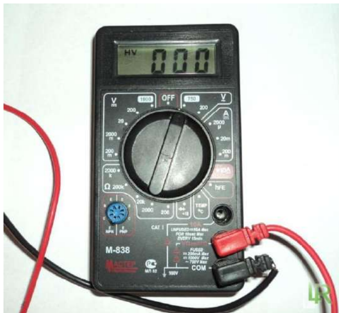
Рисунок 8.4 – Перемикання на змінну напругу
