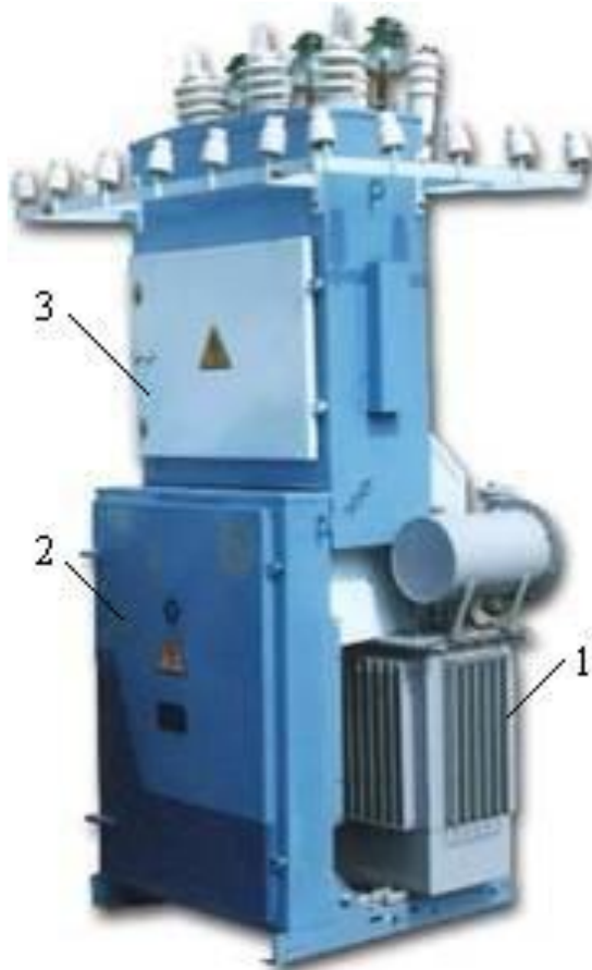
Рисунок 8.8. Зовнішній вигляд КТП-250\10\0,4-У1: 1 – трансформатор, 2 – РУ з боку низької напруги, 3 – установка з боку високої напруги
