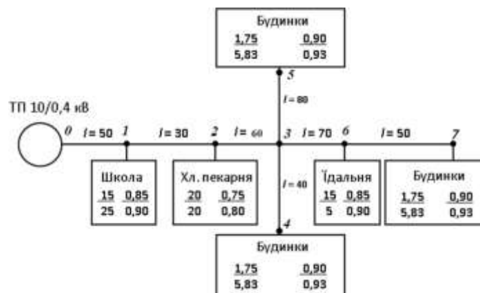
Рисунок 9.1 – Розрахункова схема повітряної лінії 0,38 кВ Розв’язання.
