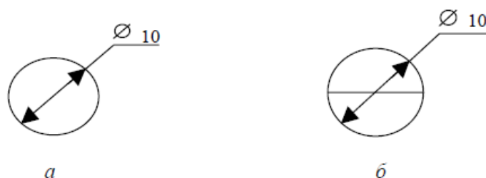
Рис. 4.3. Умовне зображення приладів, встановлених: а – безпосередньо на технологічному обладнанні; б – на щиті керування
