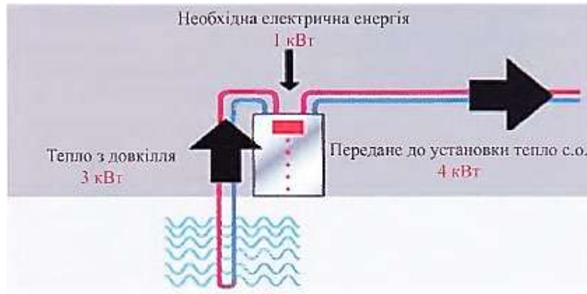
Рис. 2 - Схема розподілу енергії в теплонасосній установці
