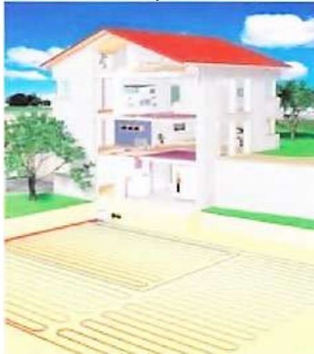
Рис. 1 - Ідеальна, спрощена схема установки з горизонтальним тепловим насосом
