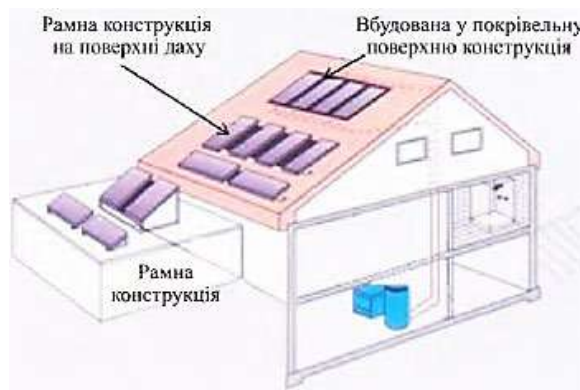
Рис. 1 - Способи монтажу сонячних колекторів
