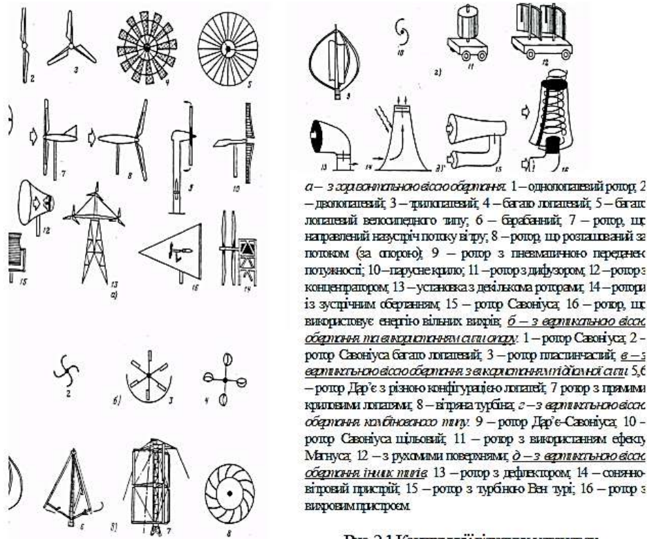
Рис. 2.1 Конструкції вітряних установок.
