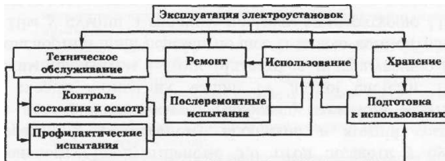
Рисунок 1.1 – Структурна схема експлуатації електроустановок
