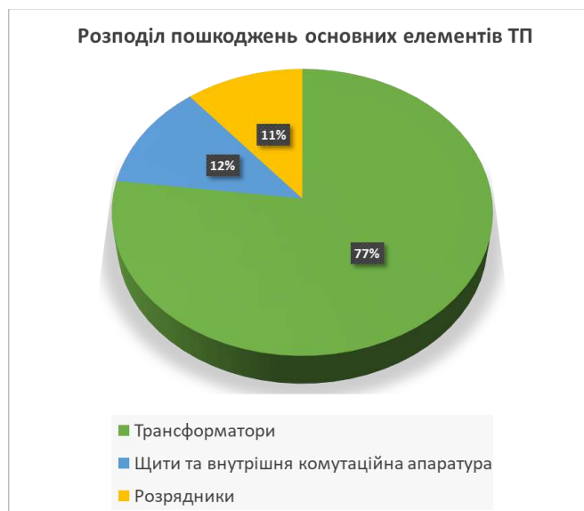
Рис. 2. – Відсоток розподілу пошкоджень основних елементів трансформаторних підстанцій
