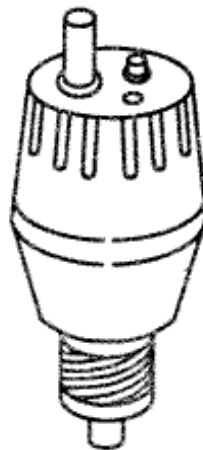
Рис. 1. Загальний вигляд автоматичного різьбового запобіжник типу ПАР-6.3
