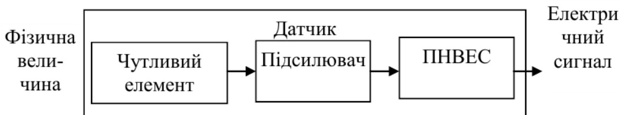
Рисунок 8.1 – Будова найпростішого датчика
