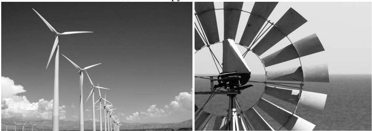
а) б) Рисунок 4 – Загальний вигляд вітроустановок з горизонтальною віссю обертання ротору а) швидкохідний ВГ; б) тихохідний ВГ.
