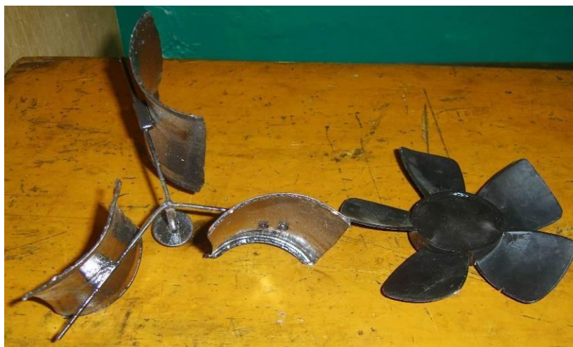
Рисунок 7. – Змінні конструкції роторів лабораторного ВГ: а) з вертикальною віссю обертання ротору; б) з горизонтальною віссю обертання ротору.
