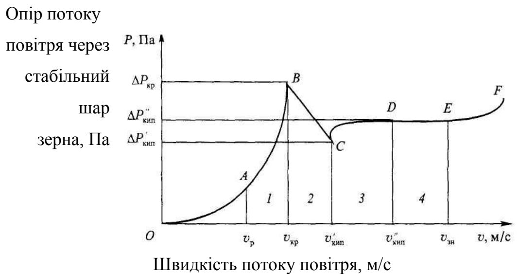
Рис. 6.1. Залежність зміни гідравлічного опору шару зерна від збільшення швидкості потоку повітря через нього:
