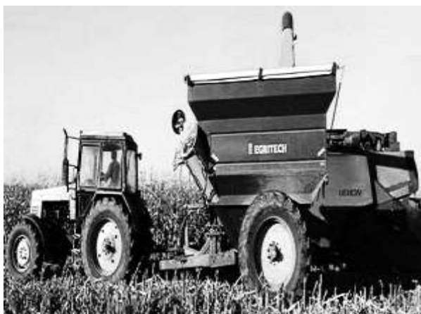
Рис. 2 – Приймання зерна від комбайна перевантажувачем
