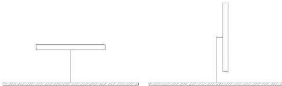
Рис. 1 - Вертикальна і горизонтальна орієнтація сонячних панелей
