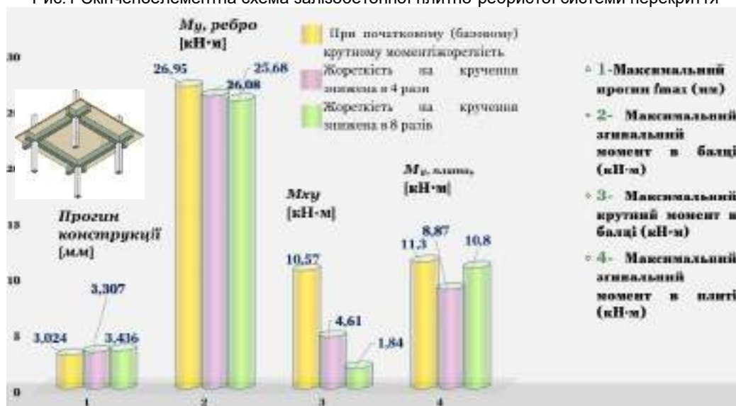
Рис. 2 Максимальні значення параметрів НДС в скінчено-елементній схемі
