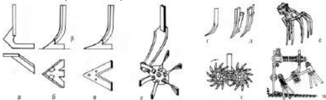
а – одностороння плоскоріжуча лапа; б – стрілочаста універсальна лапа; в – стрілочаста плоскоріжуча лапа; г – проползувальні диски; г – проползувальні диски; і – долотоподібні лапи; л – підхвілюючий ніж; є – пружинна борона; і – долотоподібні лапи; д – підхвілюючий ніж; є – пружинна борона; є – ротаційні голчасті диски; ж – проползувальний ротор;
