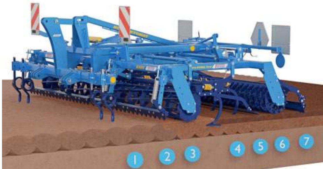
Рис.1. Агрегат для передпосівного обробітку ґрунту Kompaktomat [3]
