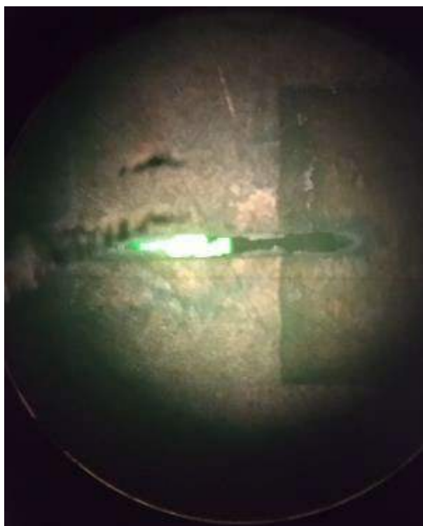
Рисунок 1 – Форма сопла гідравлічного розпилювача після сезонної експлуатації
