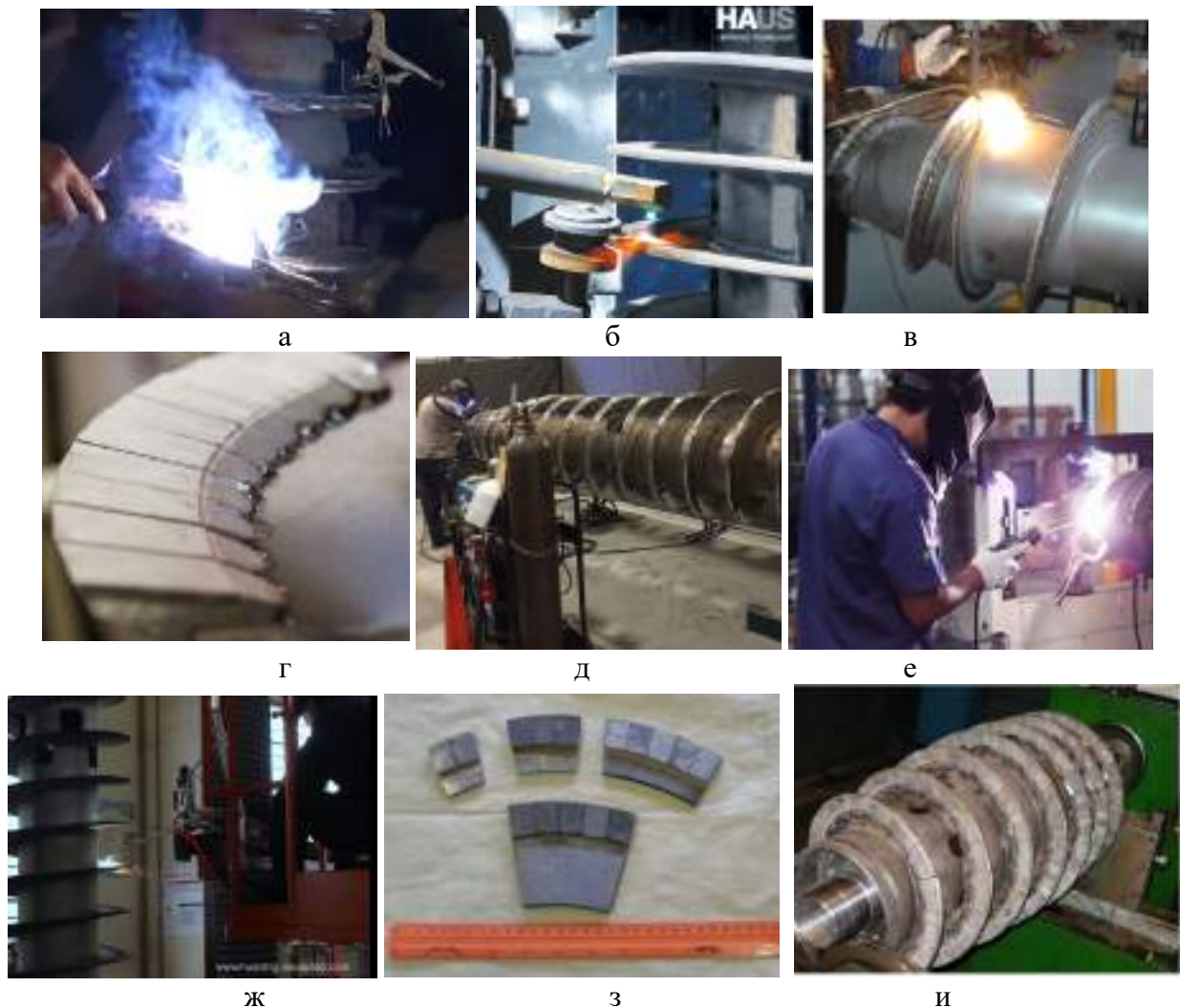
Рисунок 1 – Ремонт і зміцнення зношених ділянок шнеків центрифуг: а - зварювання сегментів і твердосплавних пластин на виробництві Rotating Equipmet Repair, LLC (США) [5]; б – нанесення покриттів з карбиду вольфраму шляхом плазмового напилення на виробництві HAUS (Туреччина) [6]; в – формування покриття або приварювання сегментів з твердосплавними пластинами на виробництві Spomasz Wronki - Grupa Ferrum Sp. z o.o. (Польща) [7]; г – приварювання до шнеку лопаток з твердосплавними пластинами на виробництві Sabaros S.A. (Швейцарія) [8]; д – формування зносостійких покриттів на виробництві Pinnacle Industrial Services (Канада) [9]; ж - автоматизоване газополум’яне напилення зносостійкого покриття на виробництві HUADING MACHINERY CO., LTD. (Китай) [10]; з, и - формуванням краю гвинтів шнека секторами з твердосплавними пластинами шляхом зварюванням на виробництві Flutech Systems (Україна, м.Суми) [11].
