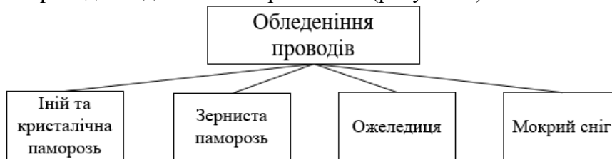
Рисунок 1 – Типи обледеніння проводів ліній електропередачі
